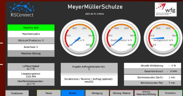
Systemgestützte Maschinendatenerfassung und Visualisierung auf einem Dashboard
